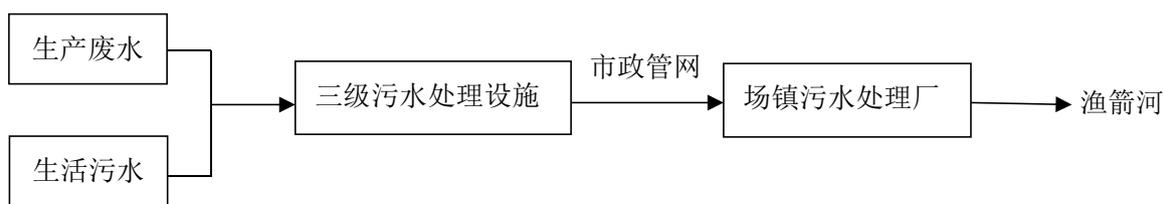
图 3-1 项目废水治理工艺流程图
